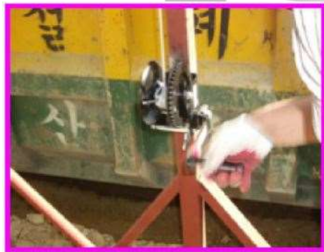
그림2: 롤링잭의 핸들을 돌려 덮개를 승하강시키는 작동도
