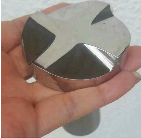
[대상 기술의 다짐부의 사시방향 사진]
